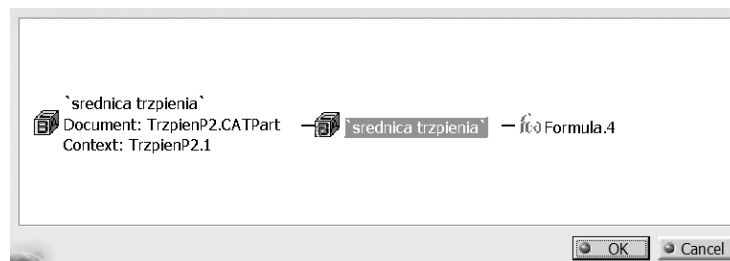
Rysunek 4.19. Wykorzystanie parametru zewnętrznego z publikowanego parametru z uwzględnieniem kontekstu zaznaczane jest znakami `...!`
